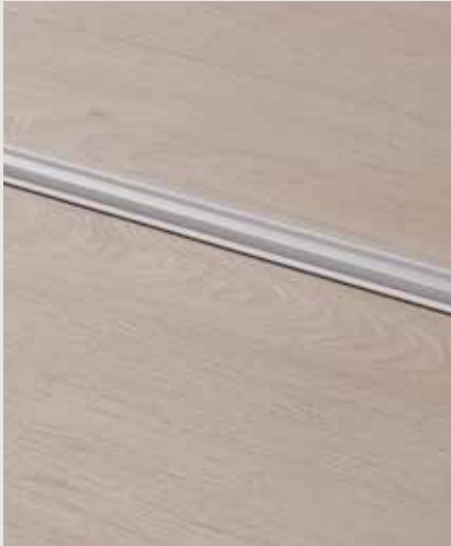
MONITOIMILISTA, HOPEA 1860 × 47 × 16 mm Liikuntasauomalista ja eritasolista samassa. Sopii 0–12,3 mm:n korkeuseroille. Korkeus: 10 mm (asentamattomana) Alumiini. PGPRSILV
